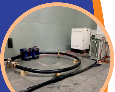
Система испытания кабеля циклическим нагревом
