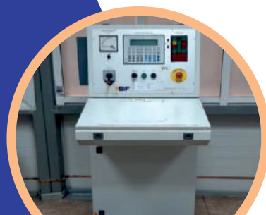
Испытательная станция SIF до 15 кВ
