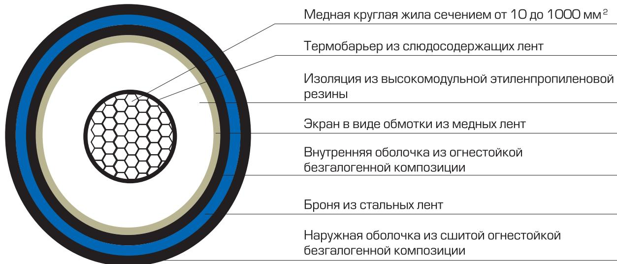
Кабель силовой марки РвЭБПнг(А)-FRHF, с изоляцией из высокомодульной этиленпропиленовой резины, экраном в виде обмотки из медных лент, бронированный стальными лентами, внутренней оболочкой из огнестойкой полимерной композиции, не содержащей галогенов, с наружной оболочкой из огнестойкой сшитой полимерной композиции, не содержащей галогенов, на напряжение 0,66-3,0 кВ. Кабель соответствует требованиям стандартов на кабели низ-
